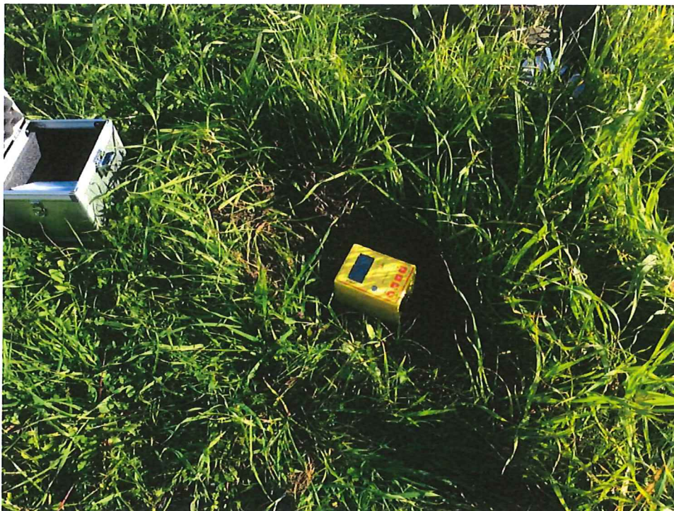
Tromino: TRZ-0181/01-12 sulla postazione di misura HVSR Lottizzazione Colle Quatrini Mare - Roseto dA
